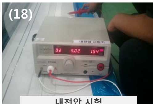
내전압 시험 (AC 1500V, 60 Hz, 1분)
